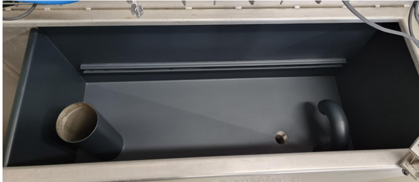
Beschichtung der Messwanne ergibt exaktere Messresultate
